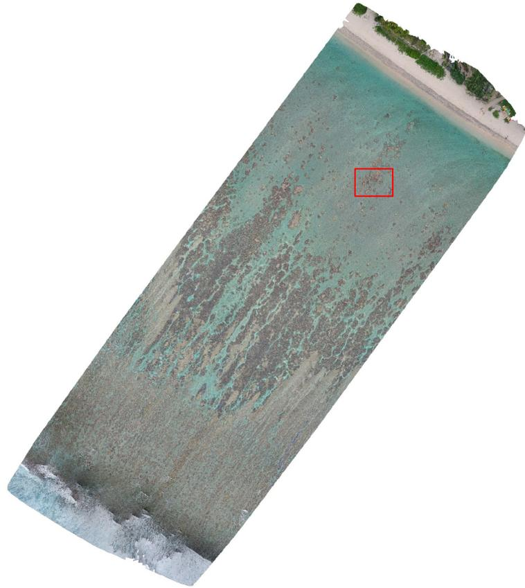
*Figure 10. Orthophoto réalisée à Trou d'eau avec des images provenant d'un UAV et géoréférencée avec GCP.*
