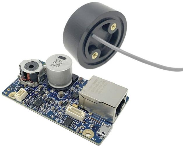
Sondeur S500 mono faisceau 5° 100m
