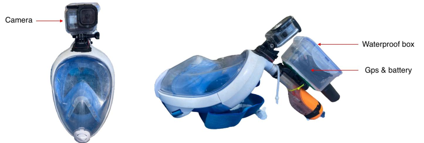
Figure 3. Plateforme citoyenne: masque avec une caméra et un GPS.
